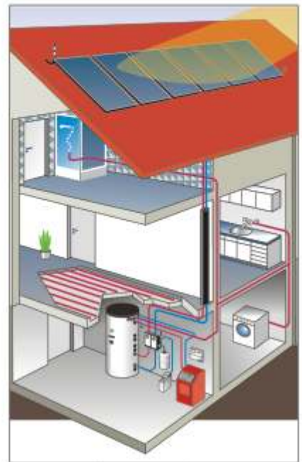
Fig. 1-3: Prezentare schematica a unei instalatii solare folosite pentru incalzirea apei potabile si incalzire centrala
